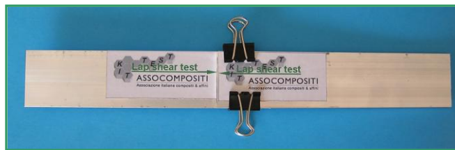
Fase di incollaggio piastrine in AL
